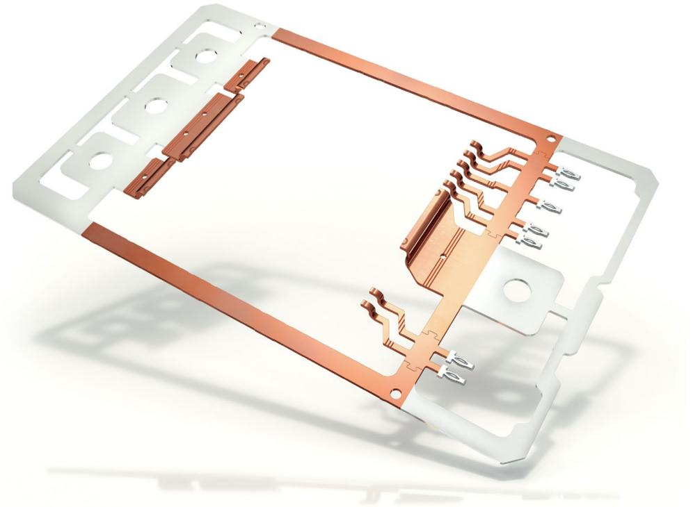
**2in1:** Durch die Entwicklung eines Universalwerkzeuges besteht bei diesem Stanzgitter z.B. die Möglichkeit, verschiedene Kontaktvarianten abzubilden. So können sowohl selektiv veredelte Löt pins als auch selektiv beschichtete Einpresszonen zugeführt werden.
